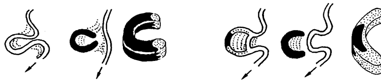
Fig. 2: Migrazione del canale e accrescimento della barra di meandro; l'erosione della riva concava e la deposizione su quella convessa procedono in coppia (da LE BLANC, 1972).
